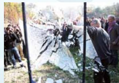
**Bombensicher.** Herkömmliches Glas bricht – die folierte Fläche bindet Splitter.
